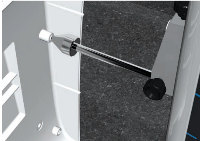
Messung des Achsabstands an einem elektronischen Plastikgehäuse
